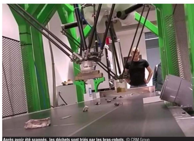
Après avoir été scannés, les déchets sont triés par les bras-robots. © CRM Group
