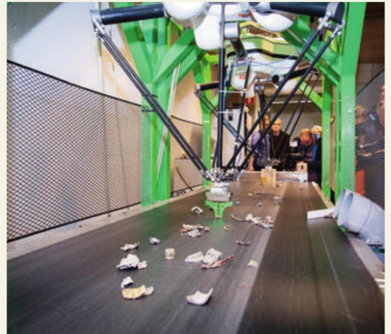
► Démonstration ce lundi à Liège d'un tri intelligent (robotisé) permettant de séparer les différents alliages... © TONNEAU
